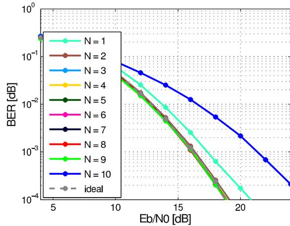
(d) BER of MC-ED with Bessel-Only filter approximation.
