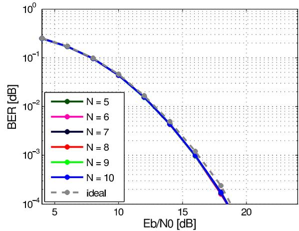
(d) BER of MC-ED with Bessel-Notch filter approximation.
