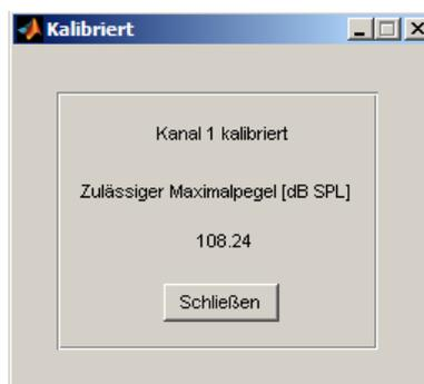
Abb. 4.11: **Meldung nach Kalibrierung eines Kanals mit zulässigem Schalldruckpegel**
