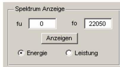
Abb. 4.6: Panel „Spektrum Anzeigen“ mit Einstellmöglichkeiten für Frequenzbereichsdarstellung
