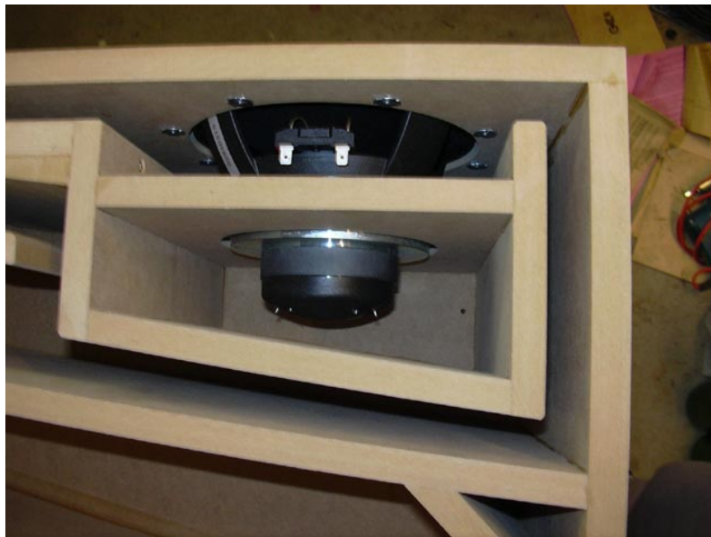
Abb. 7.6 Detailansicht vom Lautsprecher im Horngehäuse
