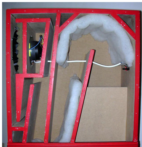
Abb. 10.10 Bedämpfung des Horns
