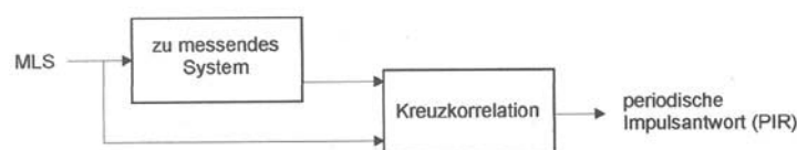
Abb. 3-1: Funktionsweise der MLS-Messung
