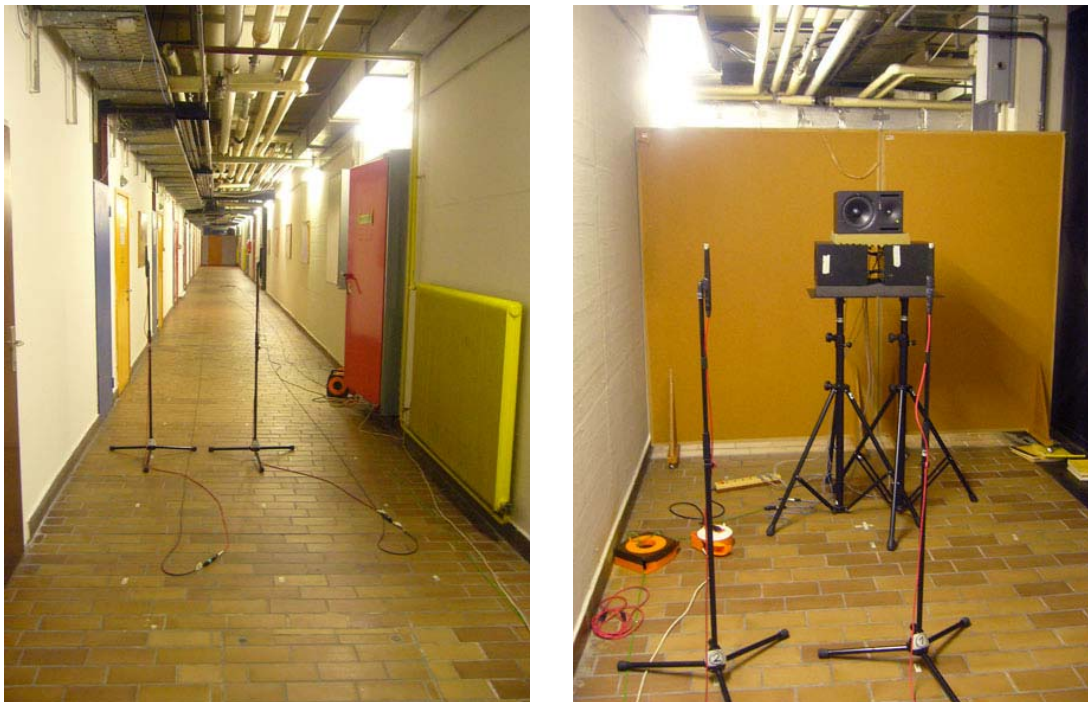
Abb. 3-10: Messaufbau der IBK Hauptmessung, Schallquelle Q2 mit Trennwand
