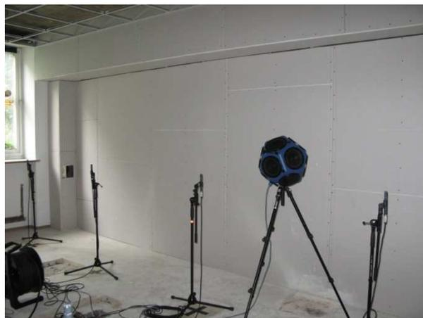
**Abb. 4.9:** Norsonic Kugelstrahler und Messmikrofone
