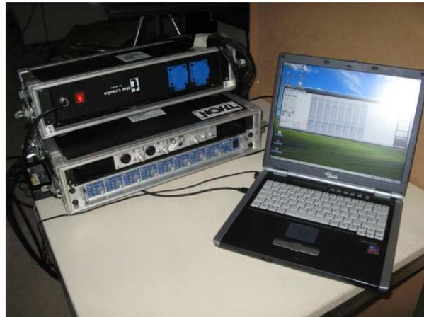
**Abb. 4.8:** Messaufbau mit Messsoftware, Vorverstärker und AD/DA Wandler
