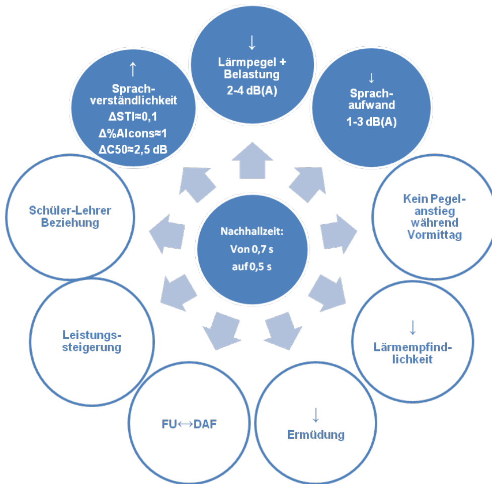
Abb. 242: Positive Effekte durch zusätzliche Sanierung der Klassenräume auf die Sollnachhallzeit. Einige Effekte, die transparent dargestellt sind, wurden in den Studien bei einer Reduzierung der Nachhallzeit auf unter 0,5s beobachtet.
