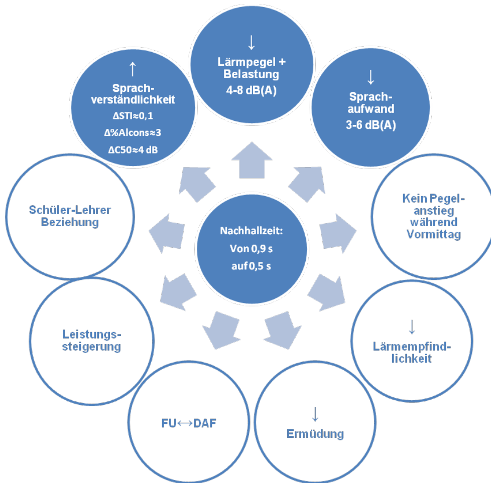
Abb. 153: Positive Effekte durch Sanierung der Klassenräume des Alten Gebäudes ( T=0,9s ) auf die Sollnachhallzeit ( T=0,5s ). Einige Effekte, die in der Abbildung transparent dargestellt sind, wurden in den Studien bei einer Reduzierung der Nachhallzeit auf unter 0,5s beobachtet.
