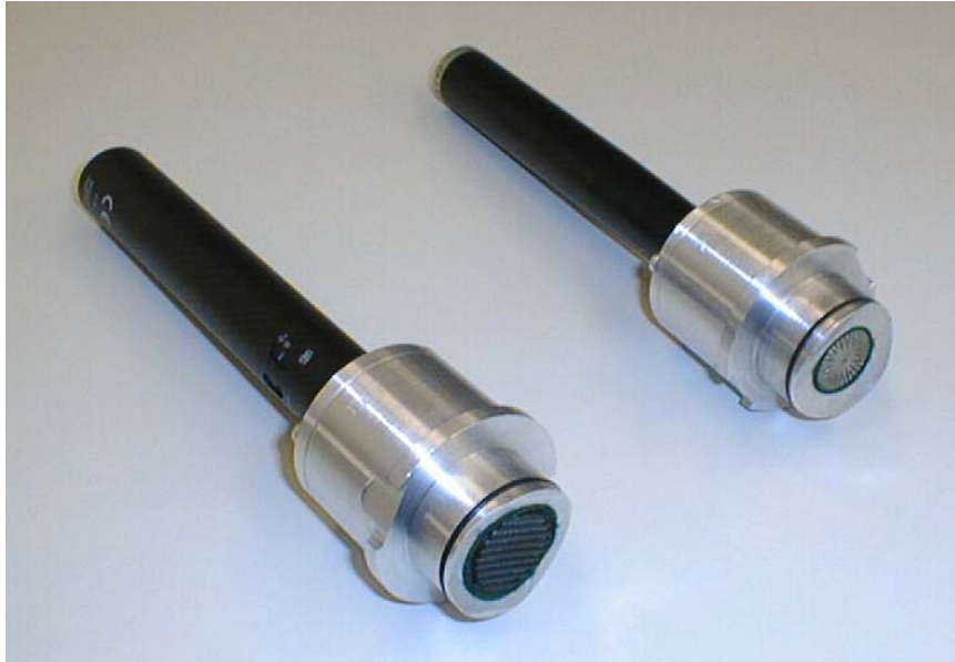
Abb. 4.15: Korrekte Montage der Mikrofone in ihren Halterungen. Links: AKG 480 Rechts: B&K 4006
