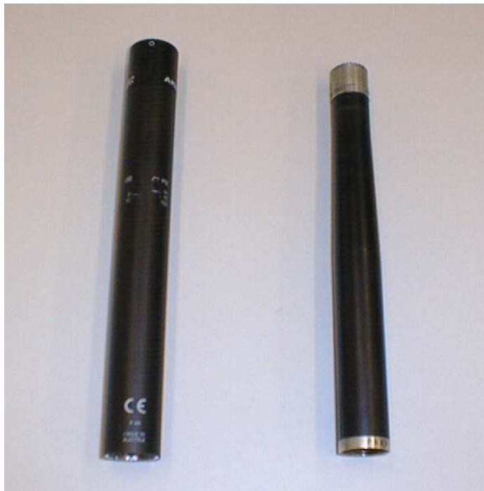
Abb. 4.13: Fotos der verwendeten Mikrofone. Links: AKG 480 Rechts: B&K 4006
