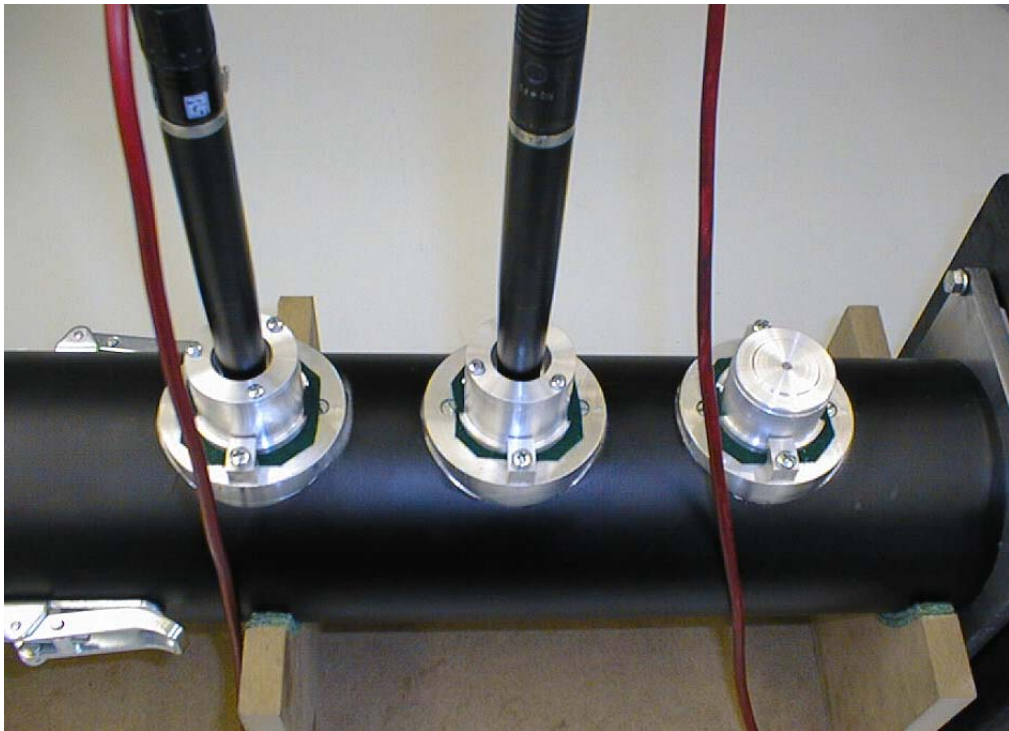
Abb. 6.4: Mikrofonpositionen für den Messbereich von 180 Hz – 1600 Hz
