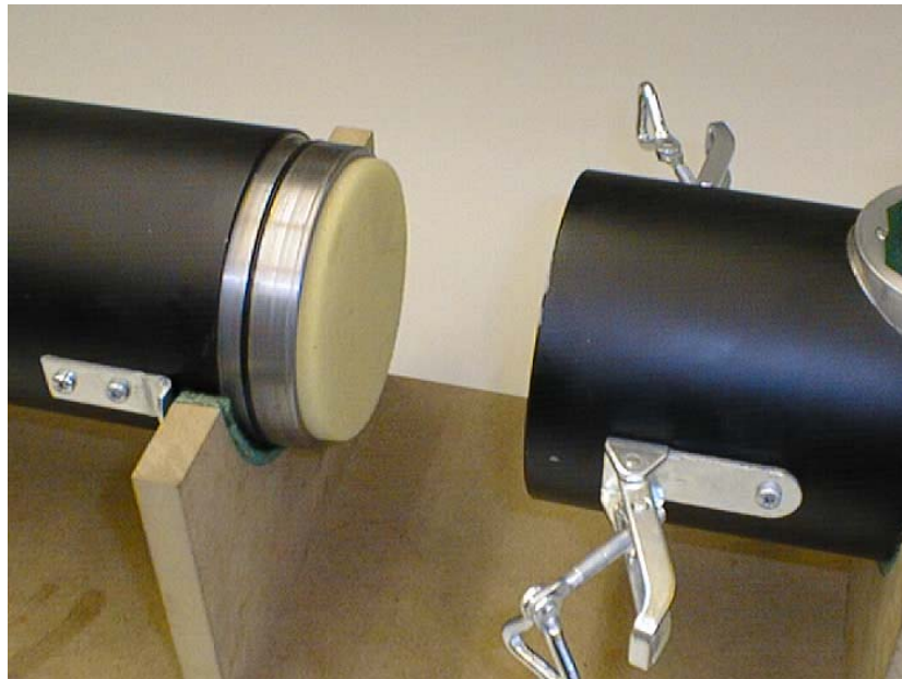
Abb. 3.19: Falsch eingebaute Probe im runden Impedanzrohr
