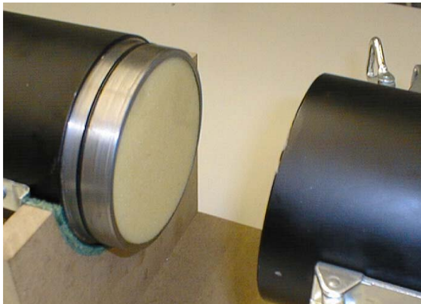
Abb. 3.20: Richtig eingebaute Probe im runden Impedanzrohr
