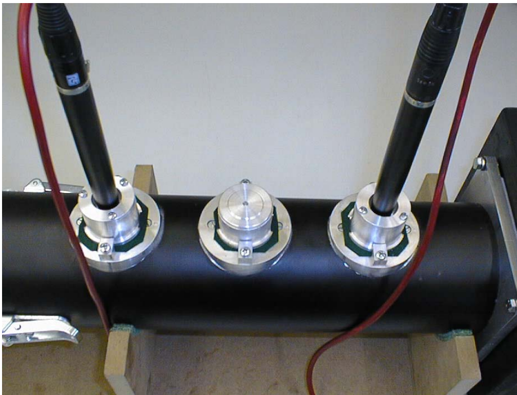
Abb. 6.5: „weiter Mikrofonabstand“ für den Messbereich von 90 Hz – 800 Hz
