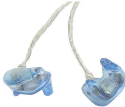
Abbildung 4.16: InEar-Hörer mit 2 wechselbaren Dämpfungsfiler (12 und 26 dB) der Firma „Ultimate Ears“ angepasst an das Gehör
