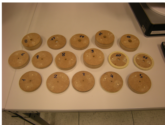
Abb. 3.1.: Aus MDF-Platten gefertigte Frontscheiben
